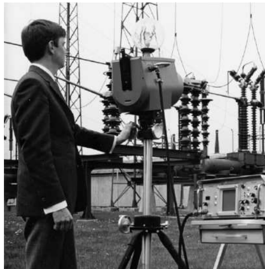
Figuur 14.2 Thermovision Model 661 uit 1969. De camera woog ongeveer 25 kg, de oscilloscoop 20 kg en het statief 15 kg. De gebruiker had ook een 220 VAC generatorset en een 10-liter vat met vloeibare stikstof nodig. Links van de oscilloscoop ziet u het Polaroid-hulpstuk (6 kg).
